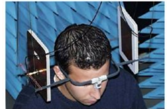
Abbildung 2.7: Headset vom Probanden getragen (hier mit Antennen für GSM900 bestückt)
